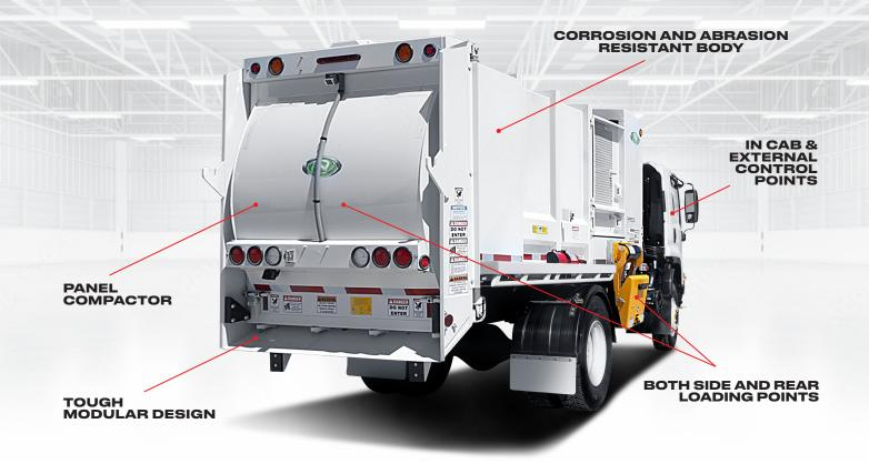
**BODY CAPACITY** 5.5 M3 - 9.1 M3 **BODY MATERIAL HARDOX 400 STEEL BIN LIFT CAPACITY** 180 KG **REAR AND SIDE LOADER POSITION LOADER** COMPACTOR PANEL COMPACTOR **CAB AND BODY CONTROL SYSTEM** CONTROLS **BIN CYCLE TIME 22-30 SECONDS**
