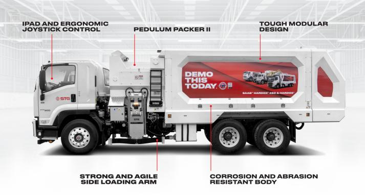
12 M<sup>3</sup> - 24 M<sup>3</sup> **BODY CAPACITY HARDOX 450 & BODY MATERIAL HARDOX HIACE STEEL BIN LIFT CAPACITY** 120 KG **LOADER POSITION** SIDE LOADER COMPACTOR **PENDULUM PACKER CONTROL SYSTEM** 12" IPAD INTERFACE **BIN CYCLE TIME 7-12 SECONDS**
